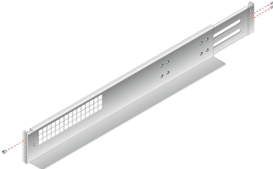
2. 如[图5-10](#)中①所示, 将滑道水平放入规划的位置, 根据机柜的长度将滑道向两侧导槽拉伸, 使滑道的固定孔与机柜内侧导槽的安装孔对齐, 滑道上前后限位销钉穿出方孔, 预定位滑道。
